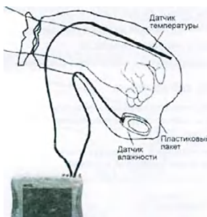
Рис. 17. Схема экспериментальной установки терморегуляции кожи
